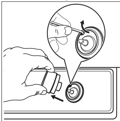
4. À l'aide d'un tournevis fin, ajustez la position de la vis de réglage (A).
